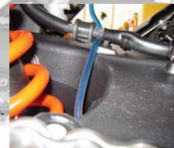
Befestigen Sie den Förderschlauch mithilfe von Kabelbindern an der Bremsleitung. **Hinweis:** Ziehen Sie die Kabelbinder nicht zu fest an.
