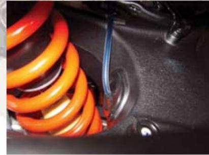
Verlegen Sie den Förderschlauch entlang der hinteren Bremsleitungen.
