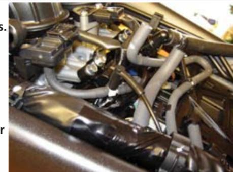
Zerschneiden Sie die Unterdruckleitung und setzen Sie das T-Stück (Teil 5) ein. Nehmen Sie den Unterdruckschlauch (Teil 3) und drücken Sie ihn in die kleinere Öffnung des Unterdruckfilters (Teil 4) ein. Drücken Sie jetzt den Unterdruckfilter auf die freie Seite des T-Stücks auf.
