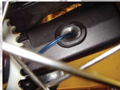
Fädeln Sie jetzt den Förderschlauch durch die obere Abdeckung und verschließen Sie beide Öffnungen wieder und ziehen den Rest des Schlauches nach. **Hinweis:** Nicht zu straff ziehen.
