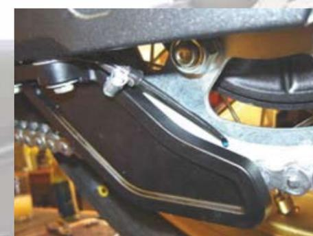
Bringen Sie die kleine Spenderplatte an der Schwinge an und befestigen Sie die Kettenfinne wieder. Biegen Sie die kleine Spenderplatte so, dass die Düse das Kettenblatt leicht berührt und der schräge Einschnitt nach außen zeigt.
