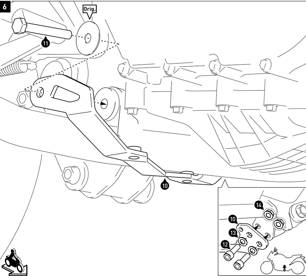
Verschrauben Sie die Querstrebe (10) mit der originalen Unterlegscheibe (Orig.) am Fahrzeug, wie in der Zeichnung und Detailzeichnung gezeigt.
