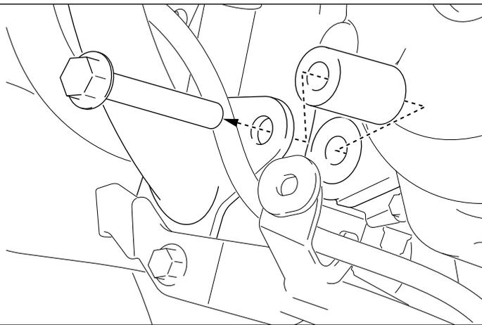
Entfernen Sie auf der linken Fahrzeugseite die gezeigte Motorhalteschraube und Distanzbuchse vom Fahrzeug.
