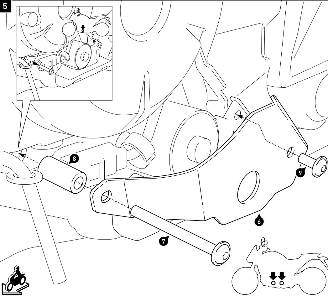
Entfernen Sie die im Detailbild gezeigte originale Schraube vom Motor.
