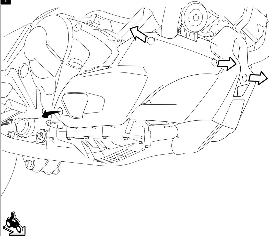
Lösen Sie auf der rechten und linken Fahrzeugseite die Schrauben der Motorverkleidung. Ziehen Sie anschließend die Motorverkleidung vorsichtig aus den seitlichen und vorderen Gummihalfterungen.
