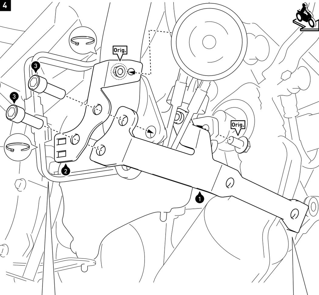
Verschrauben Sie auf der rechten Fahrzeugseite die Querstrebe (1) mit dem Hupenanbaublech (2) am Fahrzeugrahmen.
