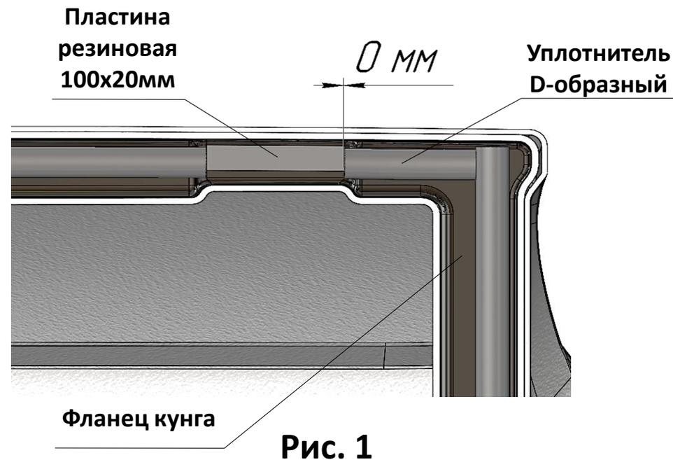
3. Установить кунг на кузов автомобиля и отрегулировать зазоры, выступы, свободное открывание и закрывание дверцы кунга и заднего борта пикапа (рис. 2).
