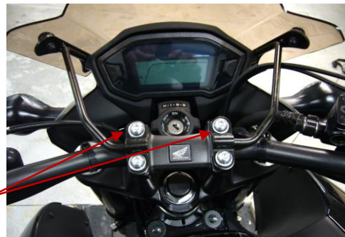
Photo 2 Vis à démonter et à remplacer
